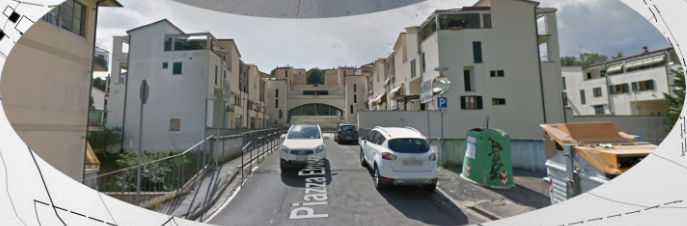
Accesso Piazza Etrusca - Marciapiedi di larghezza insufficiente - Passaggi ridotti per la presenza di manufatti (segnaletica verticale, lampioni cassonetti) - Assenza di scivoli di raccordo con la carreggiata
