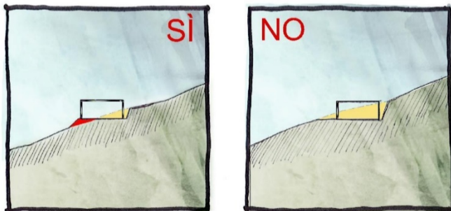
L'inserimento di nuovi volumi deve avvenire limitando gli sbancamenti (in giallo) e riutilizzando dove possibile la terra di scavo per rimodellare opportunamente le pendenze (in rosso)
